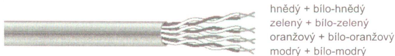
Obr. 6-8: Barevné schéma zapojení páru.
