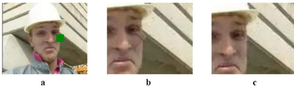
Obr. 5.8 Obnova poškodeného makrobloku v snímke a, použitím smerovej interpolácie s presným prerozdelením makrobloku na b, 4 časti c, 8 častí
