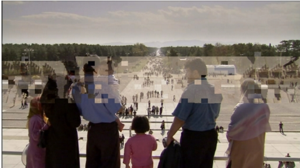
Obr. 6.10 Príklad poškodenia obrázkov spôsobeného stratou paketov a zmenou poradia paketov
