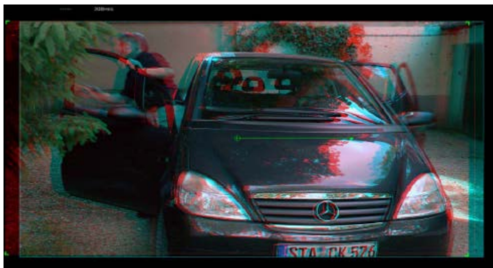
Obr. 7.52 Úprava konvergenčnej roviny pomocou shift-crop-scale počas postprodukcie.
