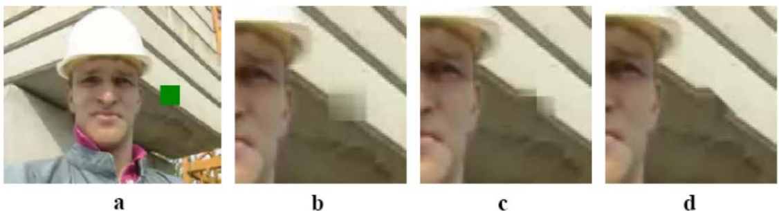
Obr. 5.3 Obnovenie poškodeného makrobloku na snímke a, aplikovaním : b, makroblokovo založeného váženého spriemerovania c, blokovo založeného váženého spriemerovania d, metódy maximálneho vyhladzovania
