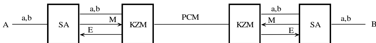
Obr. 3.18 Princip přeměny A/D s použitím EM
