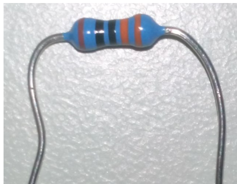
Obr. 6 Farebné označenie alternatívneho rezistora R_G
