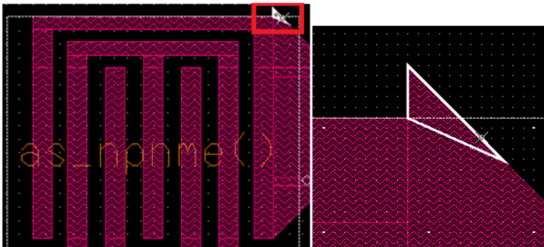
Obr. 80 Vyčnievajúci dodatok vodivej vrstvy
